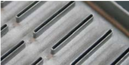
Ось так виглядає справний радіатор. Завдяки Cool-Gard II відсутні навіть найменші ознаки кавітації чи корозії.
