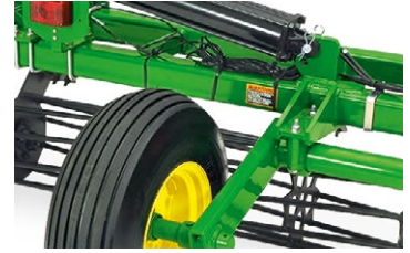
Транспортувальні колеса дають можливість пересуватися дорогою; під час роботи в полі вони піднімаються, дозволяючи переносити вагу на коток.
