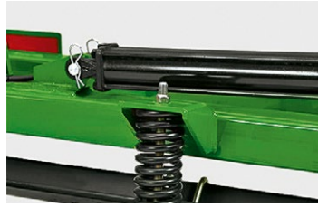
Міцна центральна рама збільшує притискне зусилля для вирівнювання поверхні поля й забезпечення ідеального ущільнення ґрунту.
