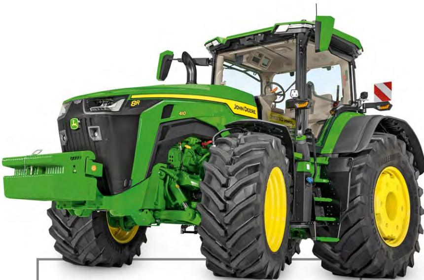
Елегантна конструкція капота з опущеною носовою частиною забезпечує оптимальну оглядовість простору перед трактором, а високе положення сидіння та велика площа заскління панелей надає можливість без будь-яких перешкод спостерігати за ситуацією як з боків, так і позаду машини.
