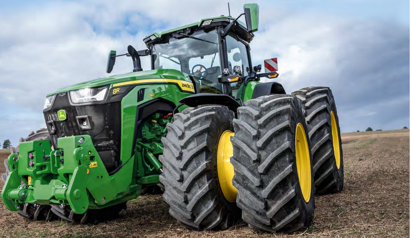
Доступна на умовах опції сумісна із системою iTEC™ передня зчіпка має максимальну вантажопідйомність 5200 кг на гаку.
