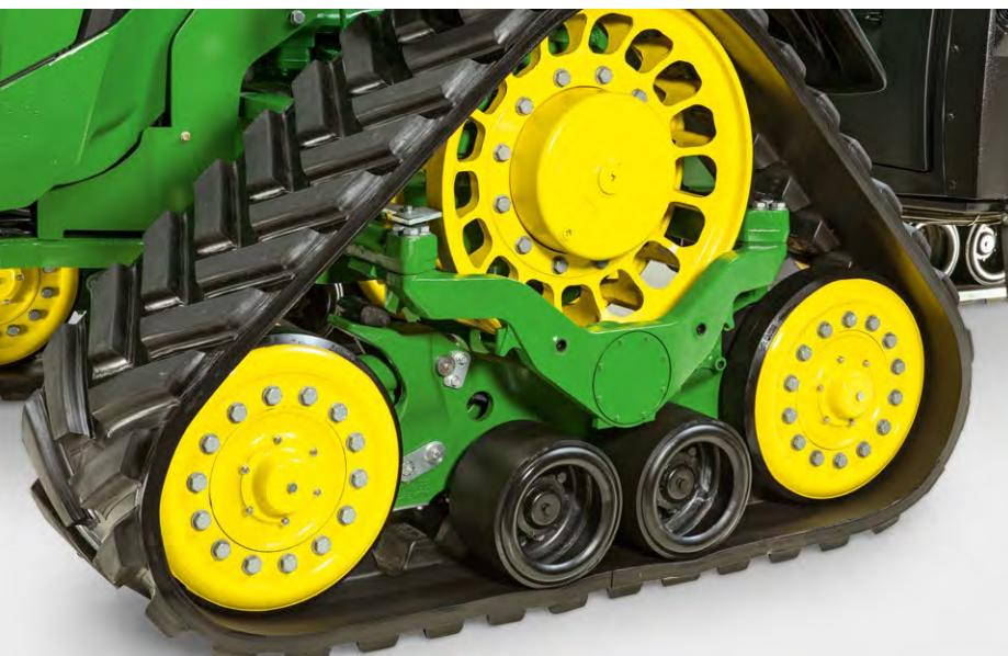
Площа контакту з ґрунтом  $4,57 \text{ м}^2$  – це еталонний показник для даного класу потужності. Навіть у разі повного баластування статичний тиск на поверхню ґрунту в задній частині не перевищує 36 кПа. Утворення гребнів на поворотній смузі майже несуттєве, хоча радіус розвороту навіть менший, ніж у колісного трактора 8R.
