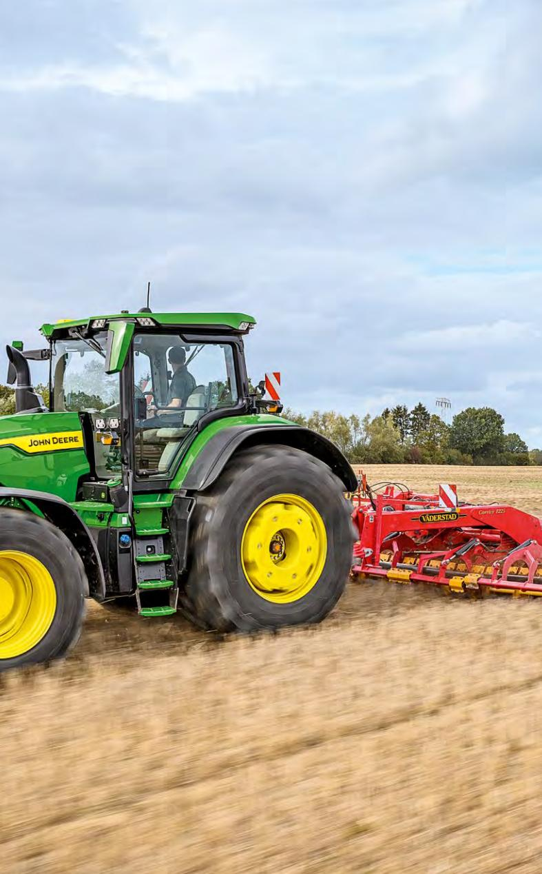
Найвищий рівень експлуатаційних характеристик у польових умовах – десять передач в основному робочому діапазоні від 5 до 16 км/год забезпечує вмикання ідеально вибраної передачі для найвимогливіших застосувань із точки зору тяги.
